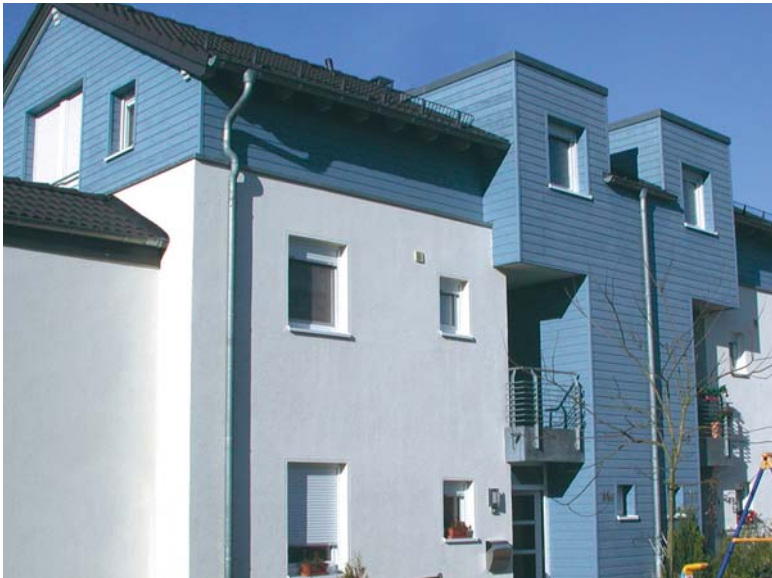
Fassadenprofile aus dem Holz-Polymer-Werkstoff Kovalex.
